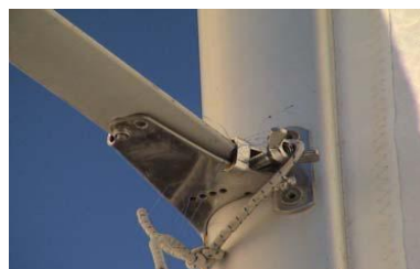
Figura 15 – sistema de afinación de crucetas
